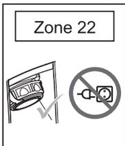
在22区: 确保设备上的电器插座关闭
